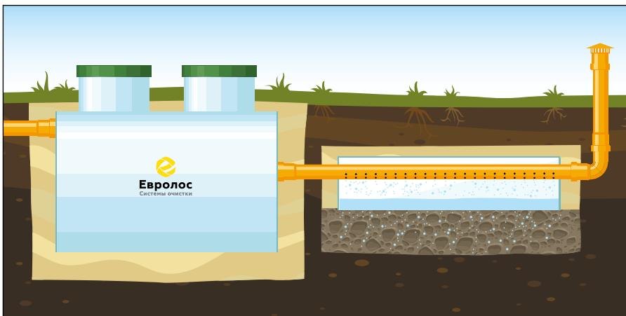
**Вариант 1.** Монтаж с применением дренажного элемента при низком уровне грунтовых вод от 1,5м и ниже.
