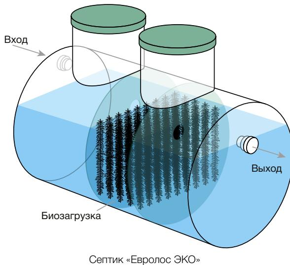
Септик «Евролос ЭКО» представляет собой горизонтальную цилиндрическую емкость с технологическими люками, а также входными и выходными отверстиями.
