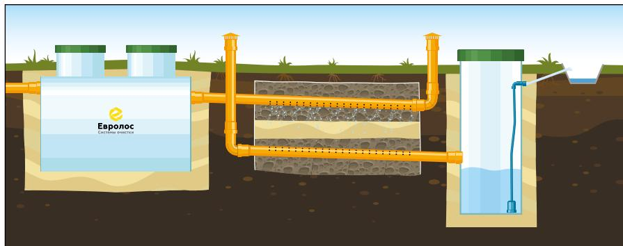
**Вариант 6.** Используется при очень плотных плоховпитывающих, либо невпитывающих грунтах.
