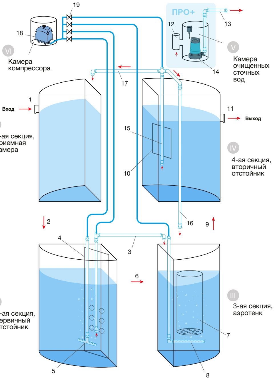
Технологическая схема очистки
